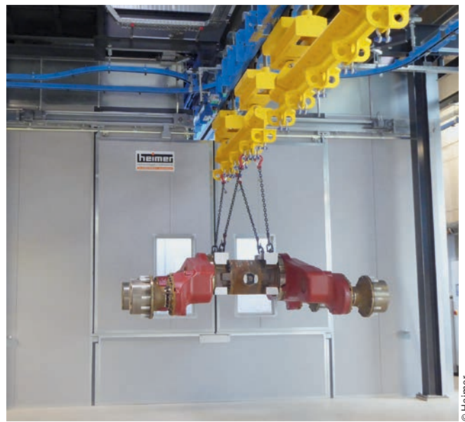
Die Beschichtung der Achsen erfolgt in der Lackierkabine durch zwei Lackierroboter der neuesten Generation. Achse hier in Warteposition vor der Kabine.
